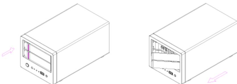
放置硬碟到硬碟抽取匣中，鎖上硬碟固定螺絲，將硬碟抽取匣插回到裝置中，即完成。
